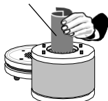
Att montera ny kolinsats
